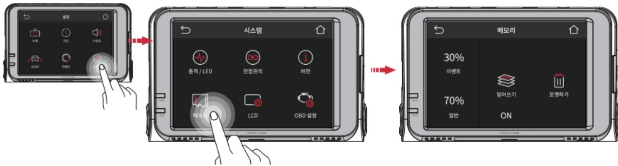
시스템 설정 화면의 메모리 버튼을 터치하면 메모리 비율 조절 및 덮어쓰기, 포맷 기능을 사용할 수 있습니다.
