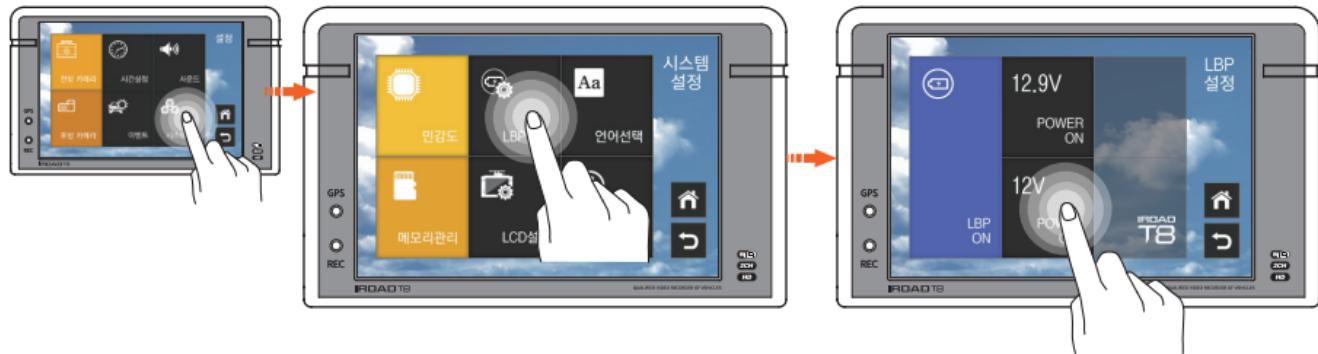
시스템 설정 화면의 LBP설정 버튼을 터치하면 LBP기능과 Power On/Off 전압값을 설정할 수 있습니다.
