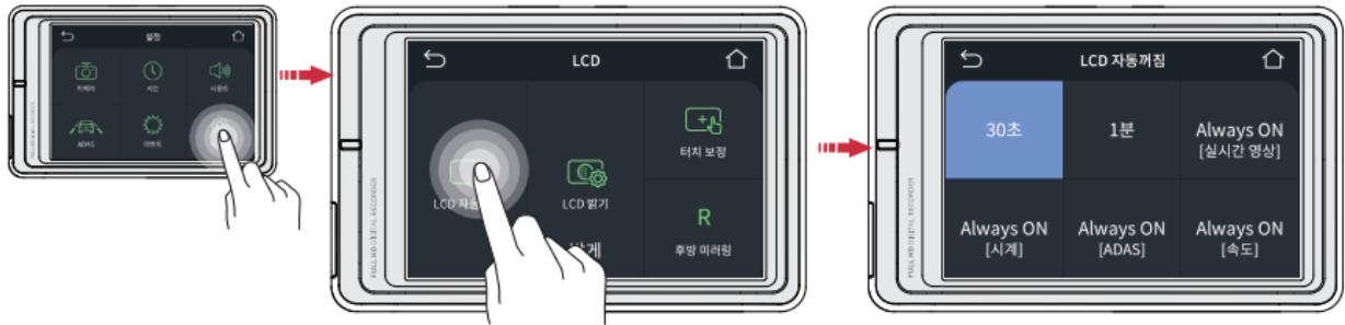
시스템 설정 > LCD에서 LCD 자동꺼짐 버튼을 터치하면 자동꺼짐시간 설정을 할 수 있습니다.
