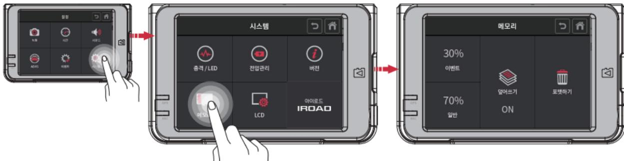
시스템 설정 화면의 메모리 버튼을 터치하면 메모리 비율 조절 및 덮어쓰기, 포맷 기능을 사용할 수 있습니다.
