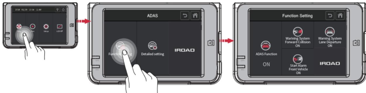
設定画面のADAS>【機能設定】ボタンをタッチすると、ADAS機能、前方衝突警報、前方車発進警報、車線逸脱警報を設定することができます。
